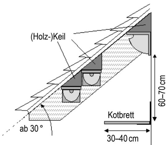
*Bei Dachneigung über 30° Kunstnester horizontal montieren! Kotbretter an der Fassade befestigen oder am Dach aufhängen (stabile Verbindung!) und so tief anbringen, dass sie den freien Nestanflug nicht behindern.*
